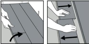
Separe toda la fila levantándola con delicadeza en un ángulo. Para separar los tablones, colóquelos en el suelo y sepárelos. Si los tablones no se separan fácilmente, puede levantarlos ligeramente a unos 5° cuando los esté separando.
